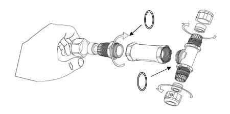
②使用するケーブル外径に合わせて、ゴムブッシュを調整する。
